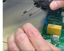
A l'**air chaud**. Cette technique est la plus efficace pour les composants CMS comportant de nombreuses pattes. On utilise un outil soufflant de l'air chaud, souvent intégré aux systèmes de fer à souder professionnel.
