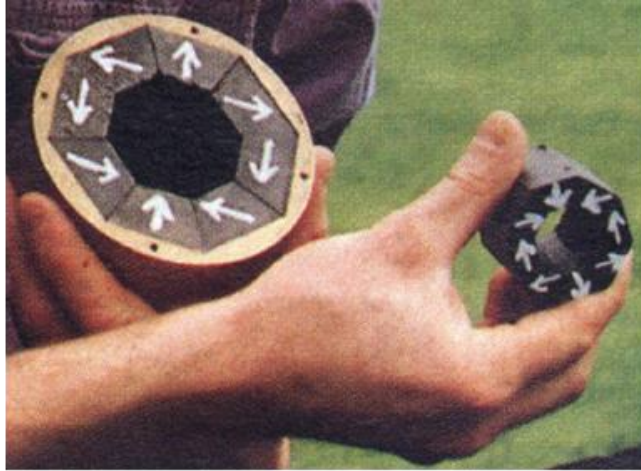
Photo 2 : Cylindres de Halbach en NdFeB massif 0,6 T (gauche) et composite 0,3 T (droite)
