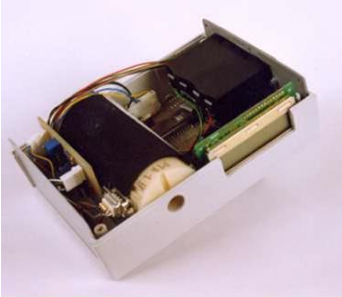
Photo 5 : Magnétomètre portable automatique - mesure des sols ferreux (brevet)
