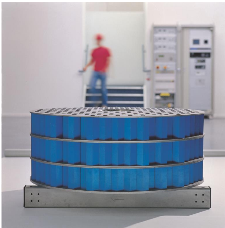
Photo 10: Aimant modulaire 1 Tesla, Ø 1m40, 5 tonnes, 580 aimants hexagonaux pour recuit sous champ de wafers MRAM 12 pouces (Magnetic Solutions Dublin)
