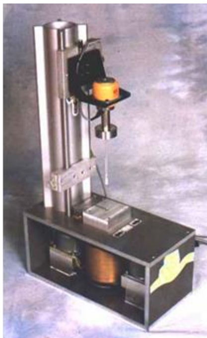
Photo 3 : Magnétomètre compact à échantillon vibrant Champ variable 0 +/- 1,2 T, sensibilité 10 -5 uem Acquisition numérique automatisée
