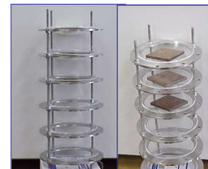
Panier servant de porte-échantillon (échantillons dans les verres de montre)
