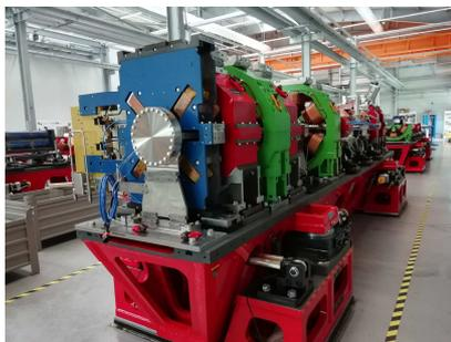
Fig. 1 : Assemblage des aimants d'optique de l'EBS sur leur supports, à l'ESRF.
