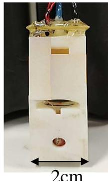
Fig. 2 : Photo du magnétomètre miniature à pompage optique
