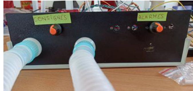
Encodeurs numériques pour la gestion des consignes et des alarmes
