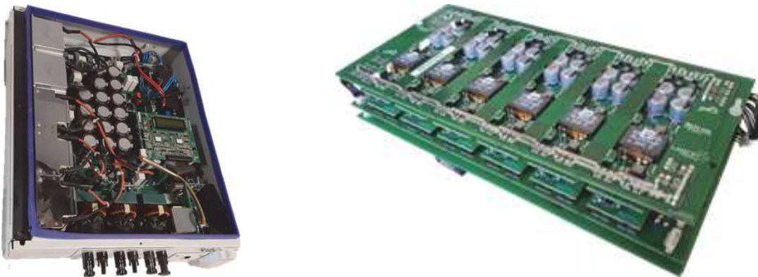
Fig.2 Comparaison de deux convertisseurs aux fonctionnalités proches, l'un traditionnel, l'autre, fortement modulaire et standardisé.
